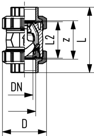
**Rückschlagventil Typ 562 (ohne Feder) PVC-C**
